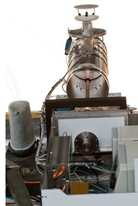
**Abbildung 3c: Aerosolmodul mit Partikeleinlass**
