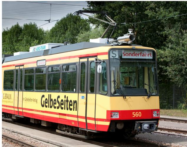
**Abbildung 3a: Seitliche Frontalansicht der AERO-TRAM mit Partikeleinlass und den einzelnen Modulen (weiße Boxen)**
