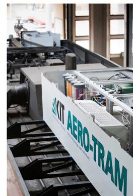
**Abbildung 3e: Hauptmodul mit Nullgasaufbereitung**
