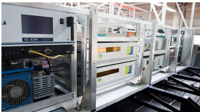
**Abbildung 3d: Hauptmodul mit Gasphasenanalysatoren**
